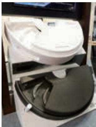
発泡スチロール模型(写真上部)を砂に埋めて注湯し、実際の鑄鉄部品(写真下部)を作る
